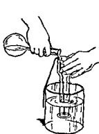
चित्र 53 द्रव नीचे से ऊपर की ओर दबाता है—यह देखने का आसान तरीका।
